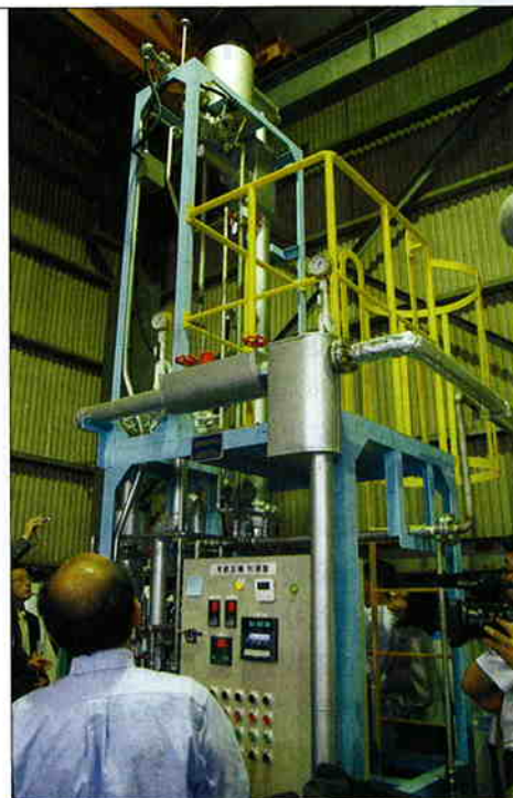
日本環境設計が愛知県今治市に設置したエタノール生成の試験プラント
